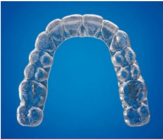
Beim Herstellungsverfahren der Invisalign-Schienen, den Alignern, kommt hochmoderne 3D-Computertechnologie zum Einsatz. Für jede einzelne Schiene berechnet der Computer ein neues Modell des Zahnbogens. Dieses wird mit den Computerdaten stereolithografisch hergestellt und mit einer dünnen Tiefziehfolie überzogen. Die auf diese Weise hergestellte Folie wird zur Schiene „Aligner“ ausgearbeitet.
